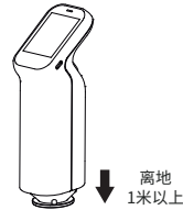
将仪器对准空气进行黑校准
