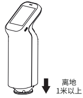
将仪器对准空气进行黑校准
